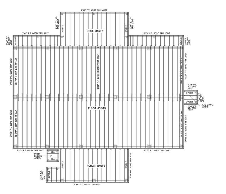
DECK JOISTS: 2"X8" P.T. WOOD JOISTS AT 14" O.C. MAX. FLOOR JOISTS: 2"X12" WOOD JOISTS AT 14" O.C. MAX. PORCH JOISTS: 2"X8" P.T. WOOD JOISTS AT 14" O.C. MAX. STAR LANDING JOISTS: 2"X8" P.T. WOOD JOISTS AT 14" O.C. MAX. A/C COMP. JOISTS: 2"X8" P.T. WOOD JOISTS AT 14" O.C. MAX.
